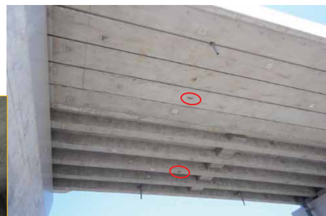
＜剥離・鉄筋露出の模擬供試体＞
