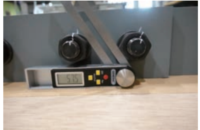
図－3 角度計を用いた回転角の計測
