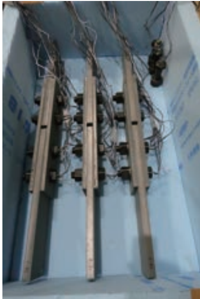
図－2 断熱材ケース内での試験体管理の様子
