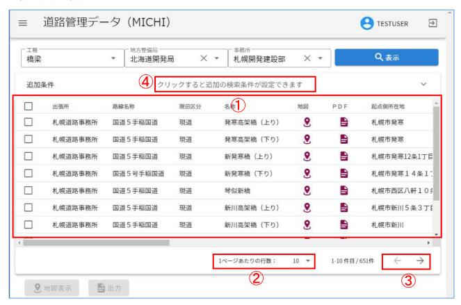
① : 工種、地方整備局、事務所、表示により選択した機関が管理する橋梁リストが表示されます
