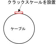
b. 模擬損傷設置のイメージ
