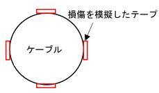
a. 模擬損傷設置のイメージ
