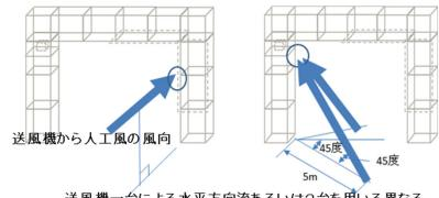
送風機一台による水平方向流あるいは2台を用いる異なる 方向からの風が合流した空間
