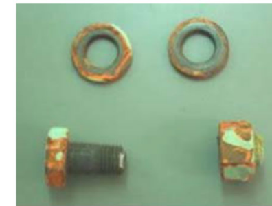
遅れ破壊したボルト
