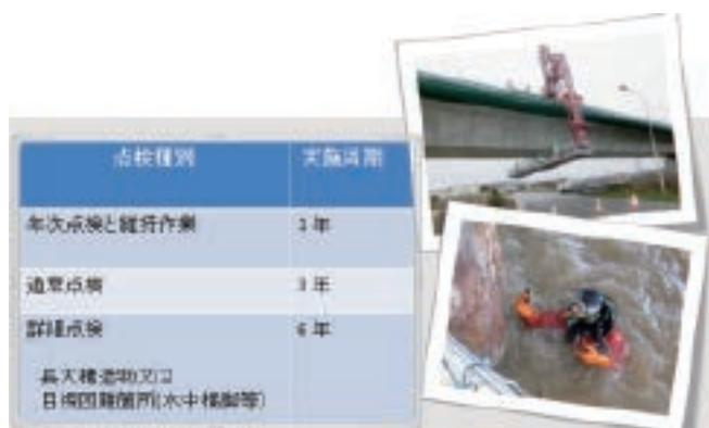
図-2 橋梁点検の種類と頻度
