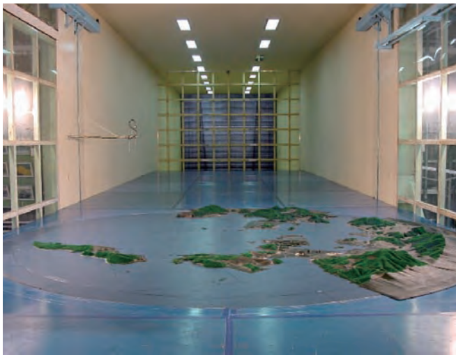
写真-3 風洞試験（地形模型）
