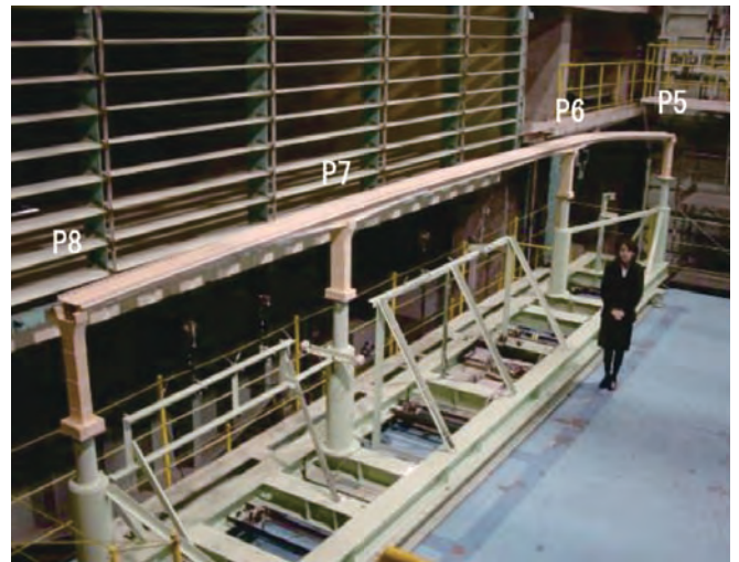
写真-4 風洞試験（橋梁模型）
