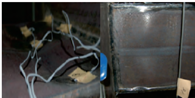
a) フランジ側 b) ウェブ側 写真-1 変形状 (実験結果)
