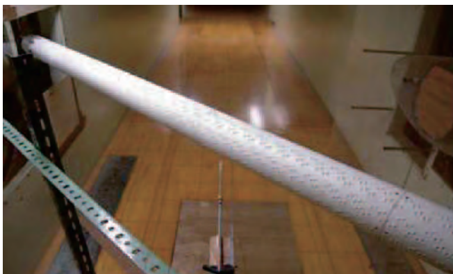
図-2 ケーブル模型設置状況
