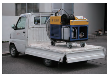
写真-3 トラックに搭載した橋梁洗浄装置 (幅：0.65m、長さ：1.2m、高さ：1.0m、重量 250kg)
