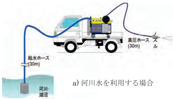
図-1 簡易橋梁洗浄装置の給水システム（模式図）
