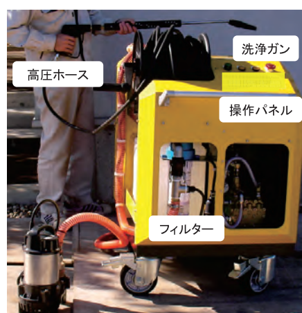
写真-2 橋梁簡易洗浄装置（側面）
