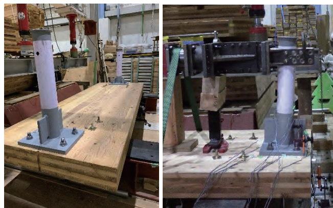
写真-11 防護柵支柱の載荷試験
