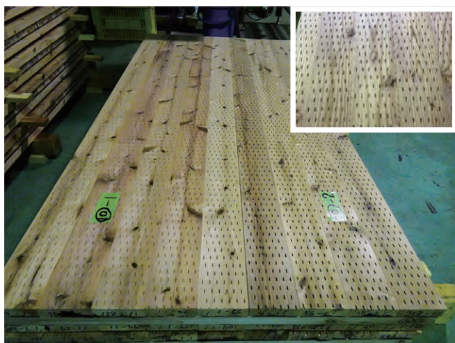
写真-12 インサイジング処理したCLT
