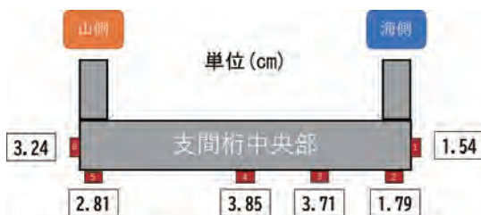
図-2.2 橋梁各部位における中性化深さの測定結果
