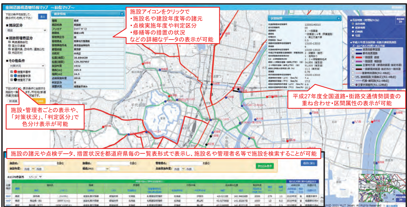
図-17 全国道路構造物情報マップ (損傷マップ)
