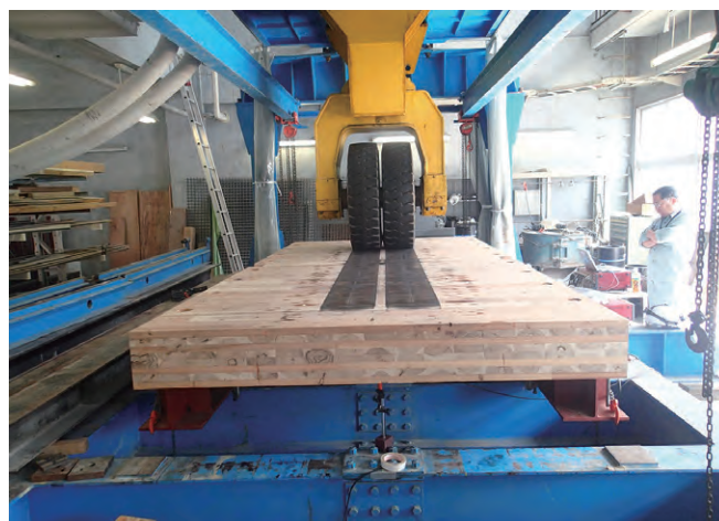
写真-3 輪荷重走行試験（山口大学工学部）
