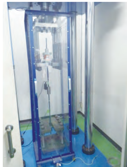
写真-6 フェーズ2 (PC鋼材張力測定)
