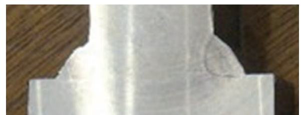
図-3 加力直角方向溶接試験片の溶接断面
