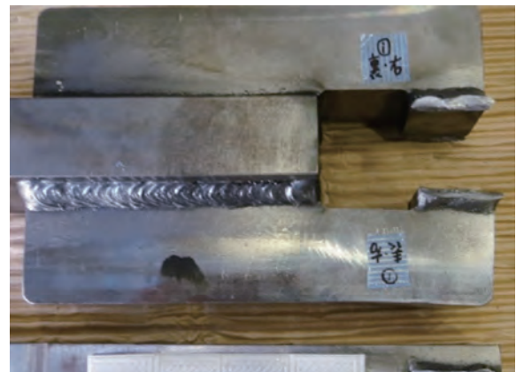
図－7 引張試験結果（加力方向）
