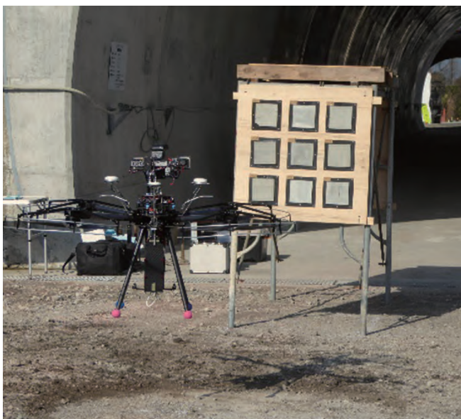
写真-3.3 模擬供試体撮影状況
