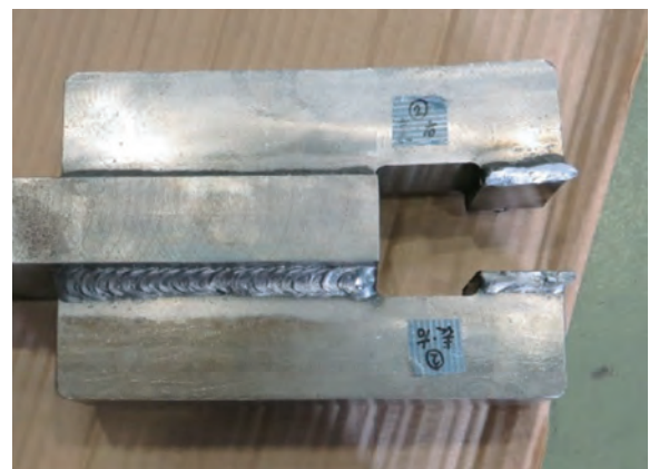
図－8 引張試験後の治具の変形（加力方向）
