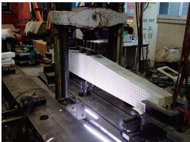
写真-1 荷重試験時の様子（P0試験体）
