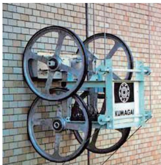
図-4 熊谷組と日本音響エンジニアリングの「壁面タイル自動検査システム」<sup>3)</sup>
