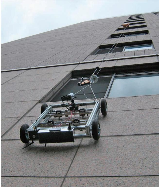
図-9 吊下げ型打音試験機によるコンクリート壁面の試験
