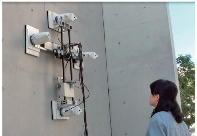
図-1 吸着盤を用いた壁面打音検査装置ライジングクロス
