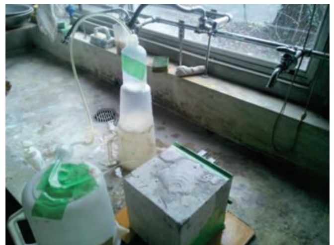
図-7 降雨と床版上面を模擬した実験の様子
