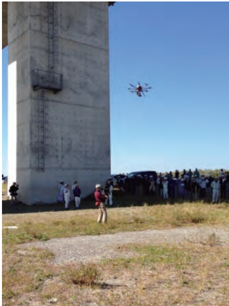
写真-2 浜名大橋の桁下を飛行するドローン型点検ロボット
