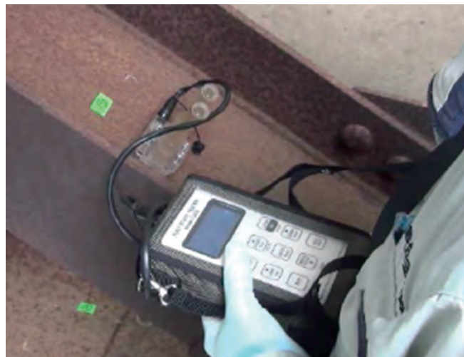
図-2 イオン透過抵抗測定状況
