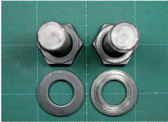
図-7 ボルトとワッシャーの接触面の状況
