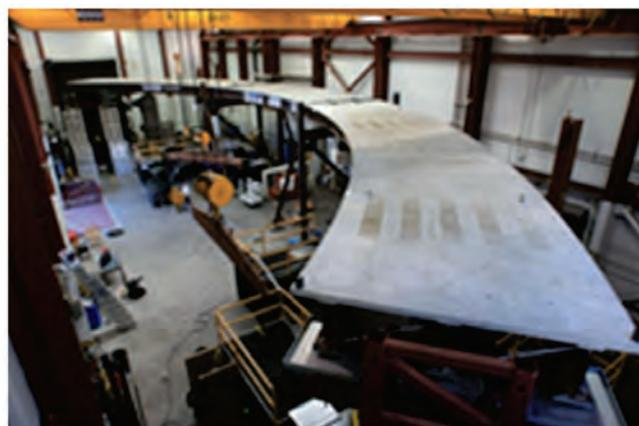
図-1 大型橋梁震動台実験の高架橋モデル
